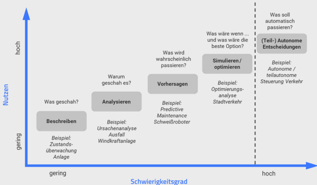
> Abb. 1: Stufenmodell Digitaler Zwillinge in der Gebäudesanierung. (Eigene Darstellung)
